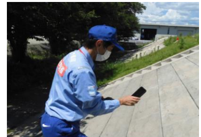
iPhoneによるLiDARを使った レーザ測量
