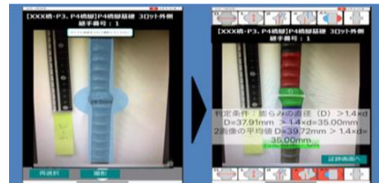
対象物を撮影 （撮影ガイド付き） 検査結果 （判定結果+計測値） デジタル圧継手外観検査（試行）
